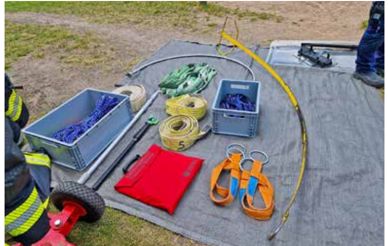
Für die Großtierrettung kommt Spezialwerkzeug zum Einsatz wie die Fädelstange (r.) oder die Schlammnadel (oben), Spezialgurte und Seile.
